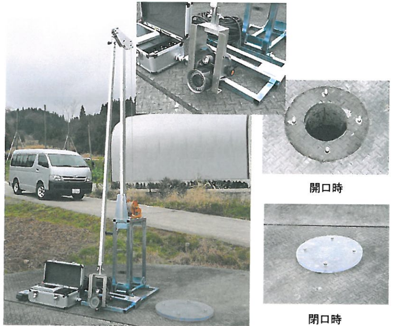
▲写真-1 集水井内点検用カメラ
